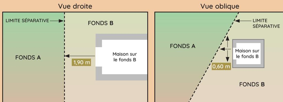
En revanche, vous n'avez aucune distance à respecter si l'ouverture donne sur un mur aveugle (sans ouverture), un toit fermé, ou encore sur le ciel...
